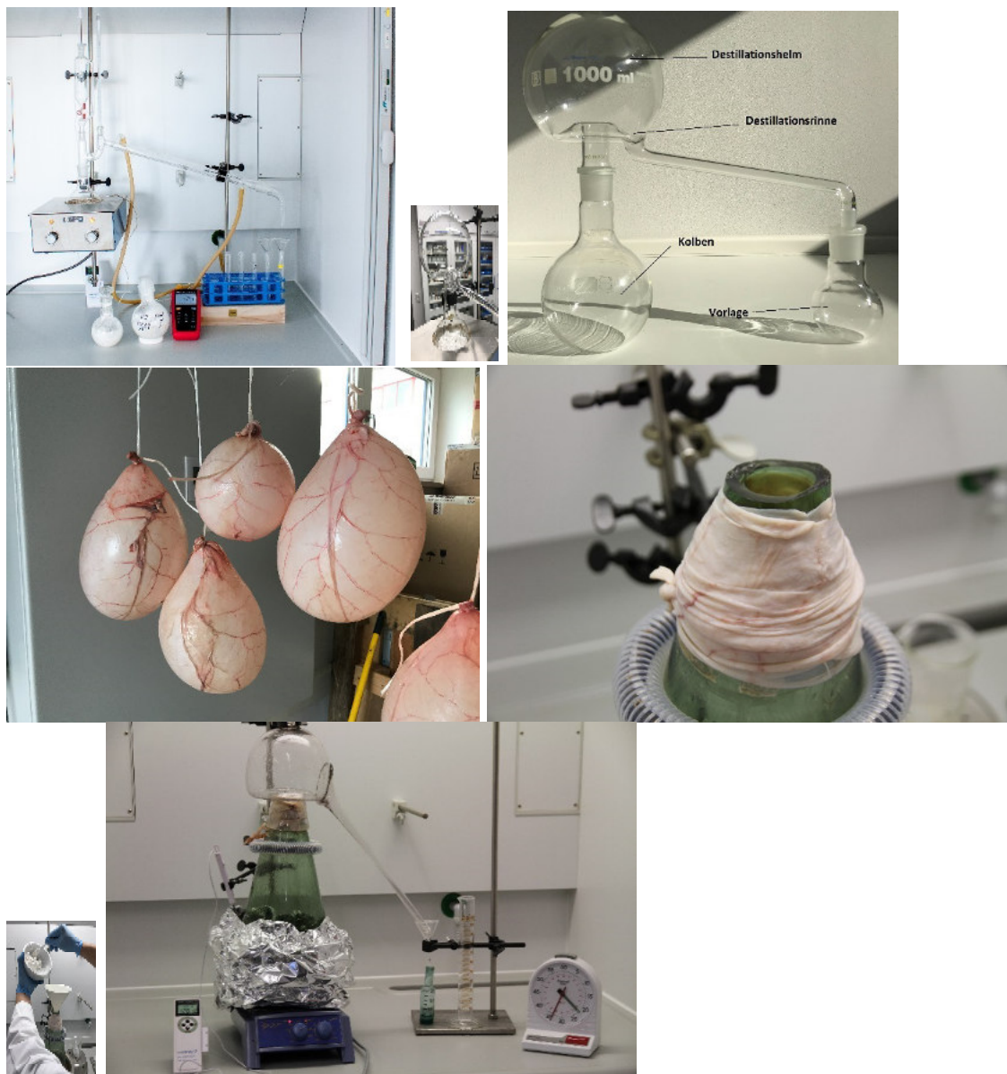
Abb.: Stufenweiser Versuchsaufbau von modern zu historisch (li nach re): moderne Destille, Durankolben mit alchemistischem Helm mit Schweineblasenprobe in Dampfphase, schematischer Aufbau der historischen Destille, Trocknung von luftgefüllten Schweineblasen, Schweineblasendichtung auf historischem Kolben, Befüllung des Kolbens mit Magma, Destillation in Originalgefäßen aus Hahnemanns Zeit.
