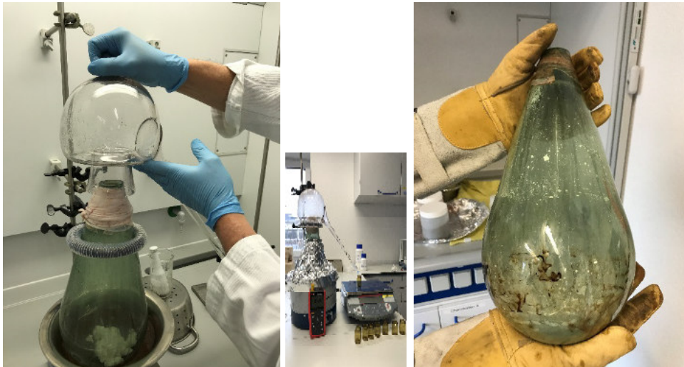
Abb: Aufkleben des Helms mit nasser Blase auf originalen Kolben und Alambik aus der Zeit ca. 1800 bis 1840, Original Versuchsaufbau, Kolben nach Causticum-Destillation mit Sprung.
