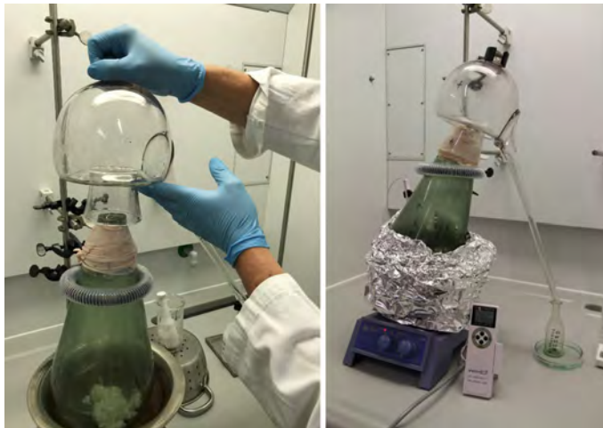
Abb. 3: Aufsetzen der historischen Alembik (= Helm) und Verkleben mit der Schweineblasendichtung des historischen Glaskolbens und anschließende Destillation von Causticum, mit ebenfalls historischen Auffanggläsern.
