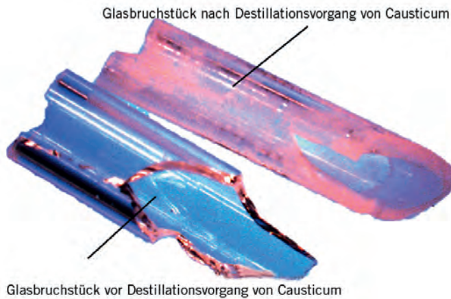
Abb. 2: Mikroskopische Aufnahme vor und nach der Destillation von Causticum mit Einlage von Kalknatronglas. Deutlich ist zu erkennen, wie die Kalilauge das Glas abätzt und trübt (Labor jaqu-invent).
